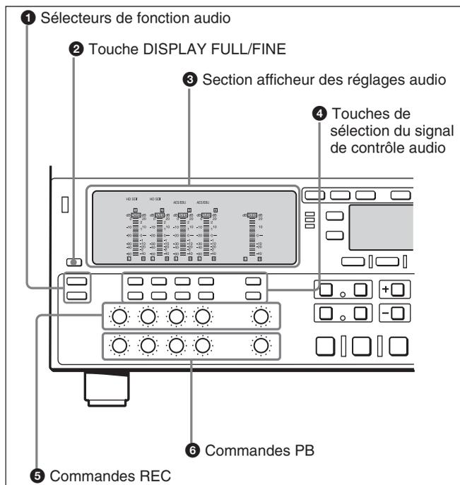
Dans la section de contrôle audio, vous pouvez sélectionner et afficher des signaux d'entrée et de sortie pour les canaux audio.
