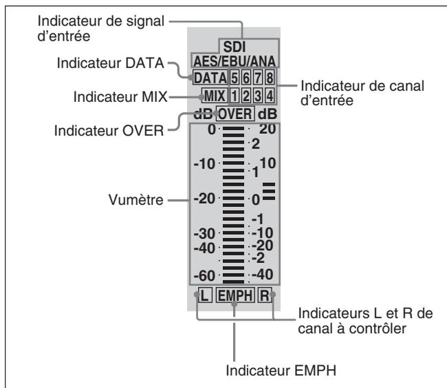
**Indicateur de signal d'entrée:** Indique le signal d'entrée actuellement sélectionné ('SDI', 'AES/EBU', 'ANA' pour analogique) pour le canal d'entrée audio correspondant.
